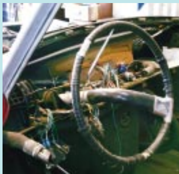
Ausgeschlachtet: Bei der Restaurierung wird die DS von Grund auf neu aufgebaut – gilt auch für das Cockpit
